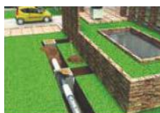
DRAINAGE Séparation/ filtration Évite le colmatage.
